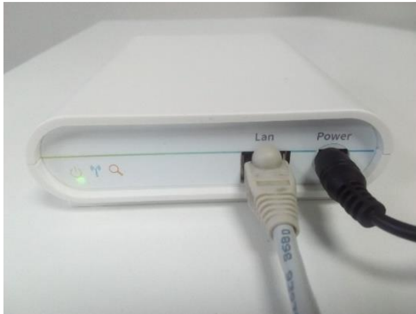
Figura 8 Conexión de pasarela domótica.
