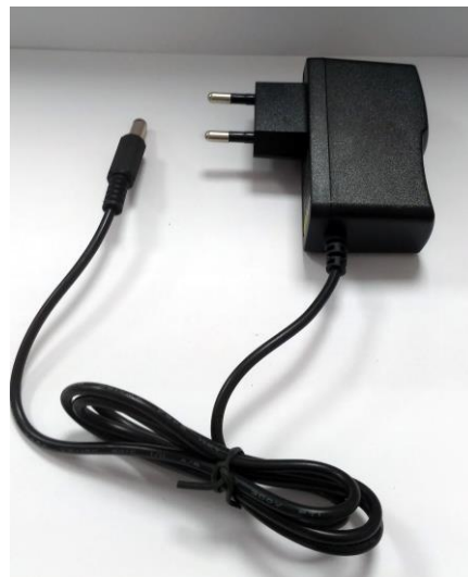
Figura 4 Alimentador de pasarela domótica.
