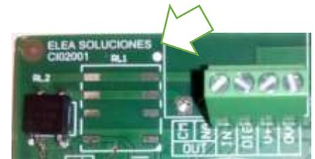
**Conexión del módulo de portero analógico si la llamada da una señal de tensión positiva.**
