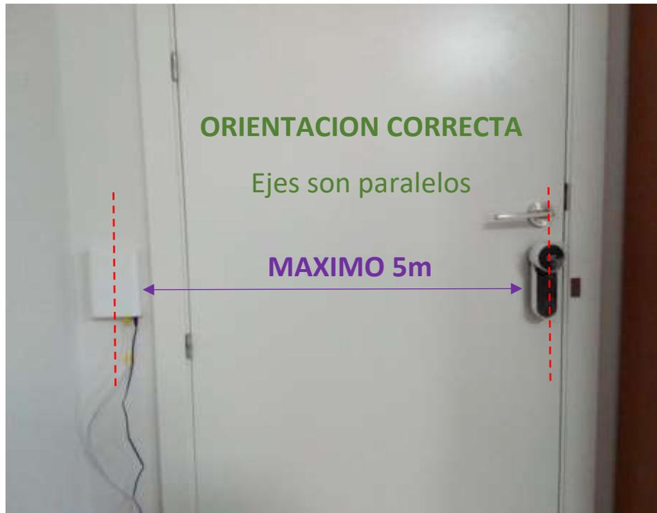
*Figura 9. Montaje en pared con orientación correcta.*
